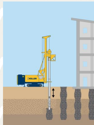
Vibro Stone Columns
